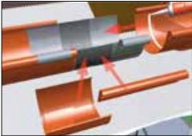
Dila-Einbau (Verbindung geklebt oder genietet)
