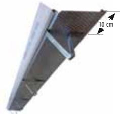
Anschließend die Rückseite der Halterung an der Rückseite des Dachrinnenschutzes festklammern. Bringen Sie alle zwei Meter jeweils vier Halterungen an.
