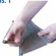
Befestigen Sie die Halterung unter dem Dachrinnenschutz, indem Sie die drei Nasen in die erste Lochreihe des Gitters einstecken. Die Höhe der Halterung kann verstellt werden, indem man die drei Nasen in die nächste Lochreihe verschiebt.
