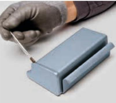
Das Lötwasser wird mit einem Pinsel aufgetragen.
