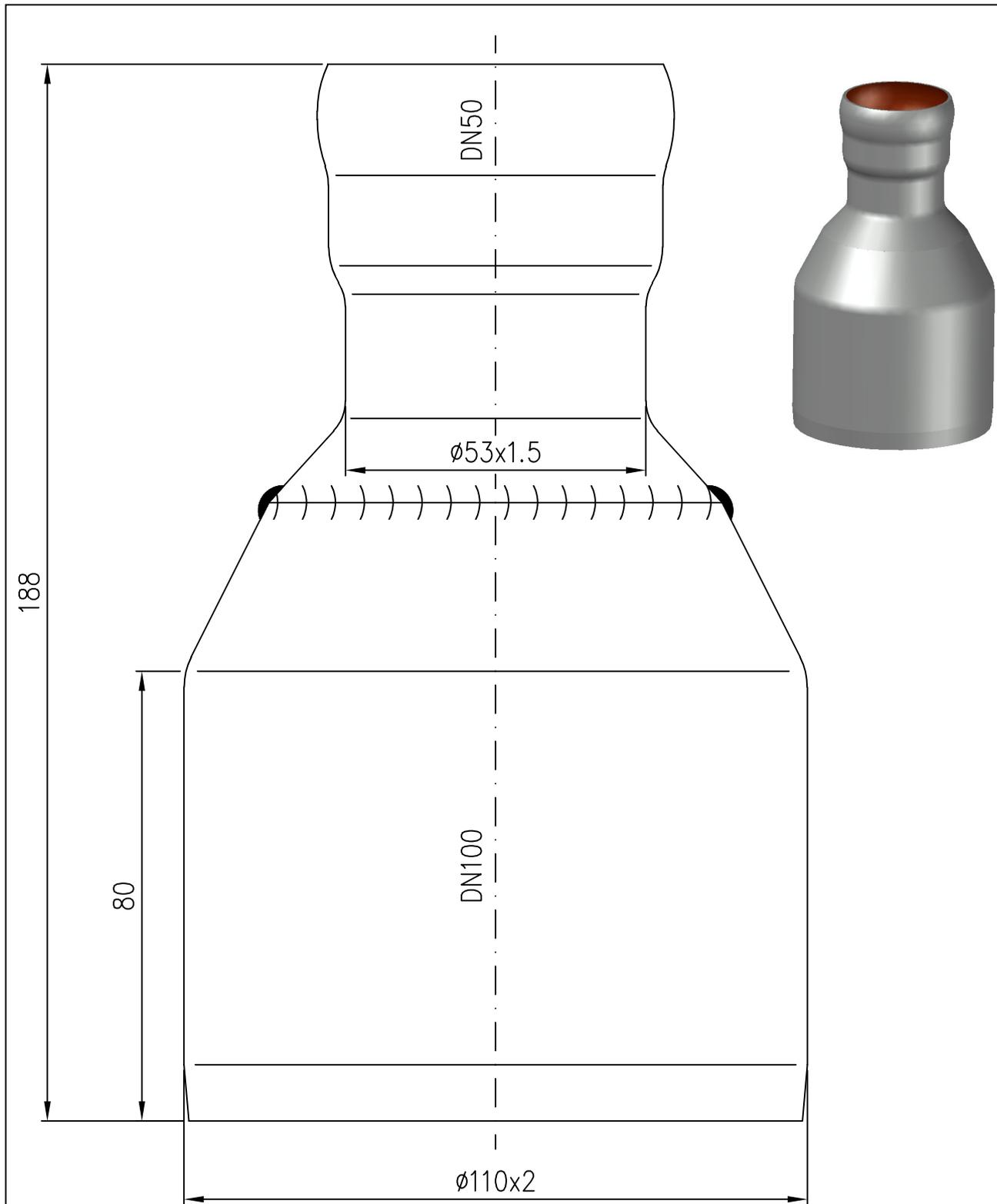
Rohrende leicht eingezogen    Werkstoff: E195 EN10305 feuerverzinkt und innen beschichtet
